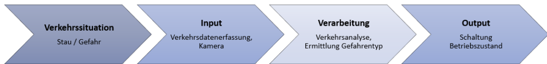
Abbildung 9: Funktionalität der Gefahren- und Geschwindigkeits-Signalisation
